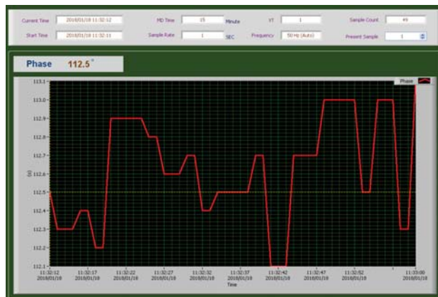
Рис. 6. Графік кута зсуву вектора напруги при переважно реактивному навантаженні
