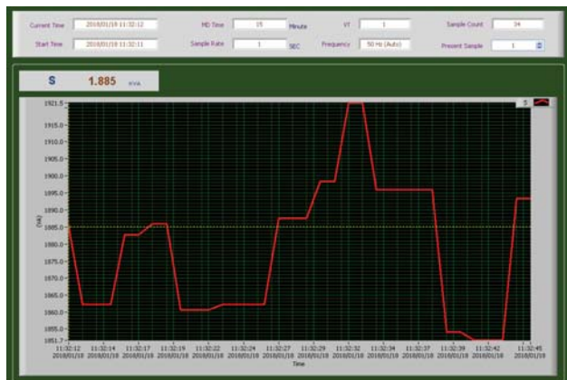
Рис. 5. Зміна повної потужності залежно від напруги мережі в часі
