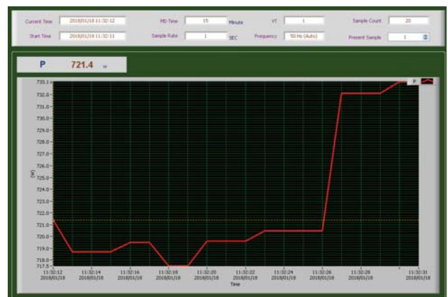
Рис. 4. Зміна активної потужності залежно від напруги мережі в часі
